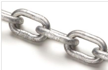
Con zincatura a caldo si intende l'immersione di manufatti in acciaio in un bagno di zinco fuso tenuto mediamente alla temperatura di 450 °C che ricopre l'acciaio con un sottile e resistente strato di zinco.
