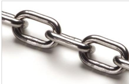
La catena viene trattata in macchinari chiamati buratti e vibratori con l'aggiunta di materiali naturali che, attraverso il contatto in movimento continuo, conferiscono un aspetto brillante ed una superficie estremamente liscia. Il processo non garantisce la protezione dalla ruggine ma garantisce un miglior aspetto al prodotto.
